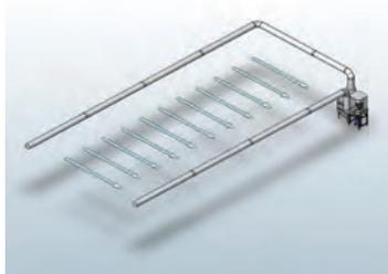
U-образная система Push-Pull с одним фильтром и одним вентилятором.
