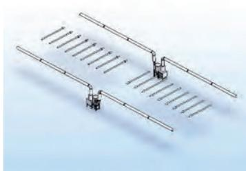
Двойная параллельная система Push-Pull с двумя фильтрами и вентиляторами.
